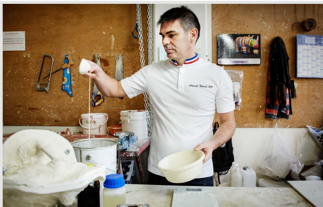
**Ci-dessus, le maître artisan, détenteur du titre de Meilleur Ouvrier de France, mélange le silicone. Il connaît la formule par cœur et l'ajuste en fonction de la température et de l'humidité de la pièce.**
